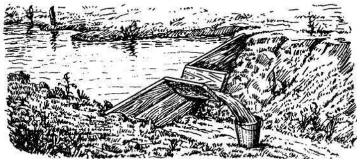
Измерение расхода воды при помощи перемычки с желобом
