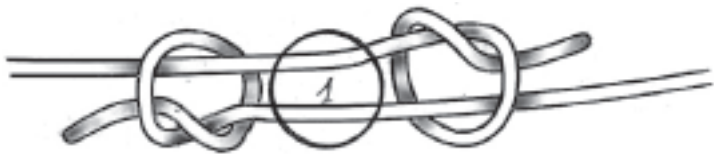
Рис. 108. Грузило устанавливается на соединенных узлами лесках
