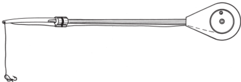
Рис. 111. Кивковая оснастка на удильнике «балалайка»
