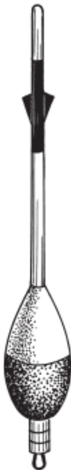
Рис. 103. Поплавок с огрузкой на киле
