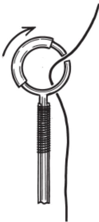
Рис. 19. Колечко вершинки удилица с разрезом и передвигающимся кембриком
