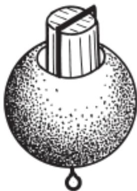
Рис. 51. Поплавок с антенной-кнопкой
