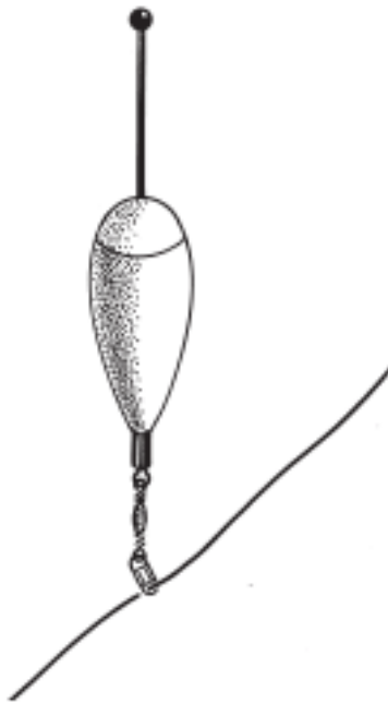
Рис. 102. Крепление поплавка через вертлюжок и карабин
