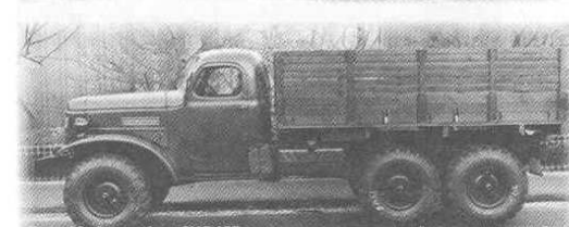
Фото 18. Автомобиль ЗИЛ-157 имел точно такие же колёса, что и автомобиль ГАЗ-66 размером 12.00-18. Внешние отличия - форма ступиц и узлов подвода воздуха к шинам
