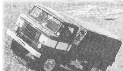
Фото 2. Тот же автомобиль ГАЗ-66-01 1969 г. выпуска с рекламного проспекта ГАЗа. Фото опубликовано в журнале «За рулем» (№ 9/1973). Хорошо виден подпятник крыла и отсутствие фары-искателя.
