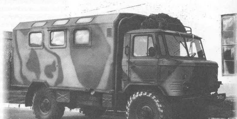
Фото 12. Мастерская связи универсального типа М-3М2 в кузове-фургоне К-66 на шасси автомобиля ГАЗ-66-05 выпуска на начало 1975 г. Виден короткий бампер, брызговики над ним нет. Пробка топливного бака закручивающаяся. Зеркала заднего вида установлены правильно – связи.
