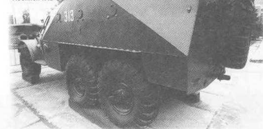
Фото 19. Бронетранспортёр БТР-152В1. Установлены шины модели К-12А Кировского шинного завода размером 12.00-18. Колёса унифицированы с автомобилями ГАЗ-66
