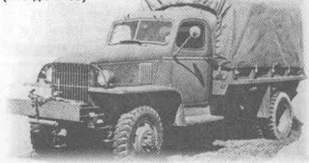
Радиофургон К-51 на шасси Chevrolet G7105
