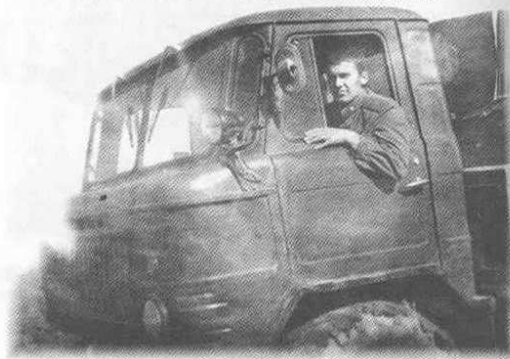
Фото 11. Автомобиль ГАЗ-66-01 выпуска начала 1967 г. Кронштейн фары-искателя высокий. Зеркало заднего вида установлено не правильно. Краснознамённый Забайкальский пограничный округ. 54-й погранотряд. 1970
