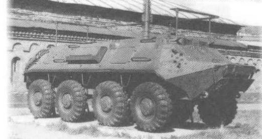
Фото 17. Войсковая радиостанция Р-145 на базе бронетранспортёра БТР-60ПБ. Установлены шины модели К-58 размером 13.00-18. Они внешне похожи, но не взаимозаменяемы с шинами К-12А размером 12.00-18 автомобиля ГАЗ-66
