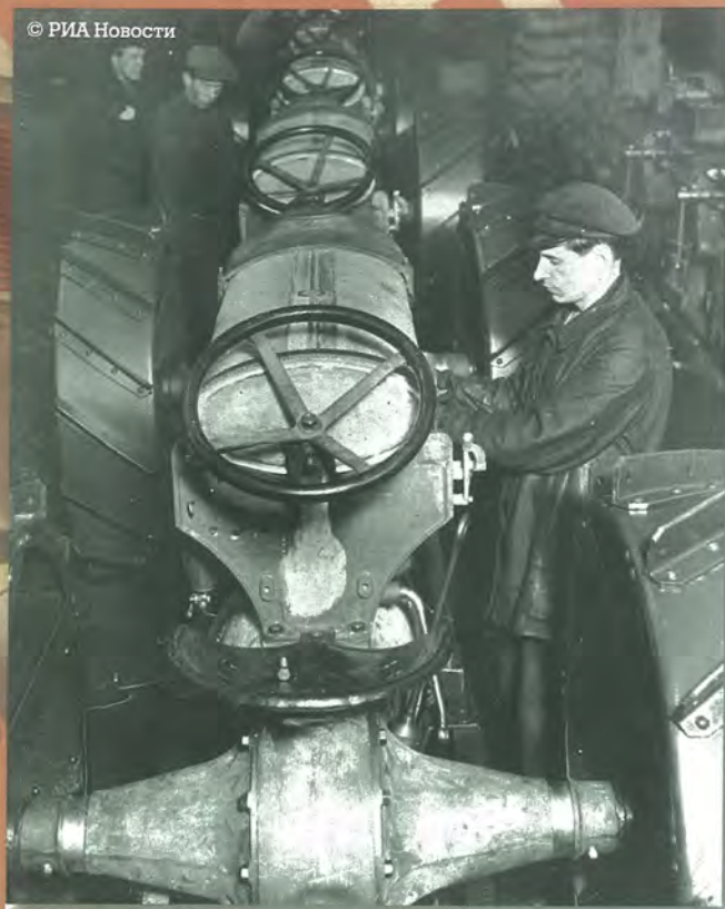
▲ Сборка тракторов на конвейере завода "Красный путиловец" (ныне ОАО "Кировский завод"). Репродукция фотографии 1928 года.
