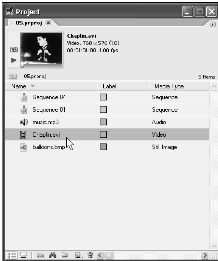
Рис. 5.2. Окно Project после загрузки ранее сохраненного проекта содержит клипы, импортированные в прошлых сессиях работы
