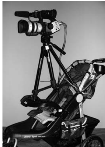
Рис. 1.30. Используем легкую детскую коляску в качестве тележки для камеры
