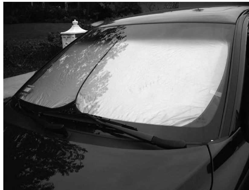
Рис. 2.17. Ветрозащитный экран, изготовленный из отражающей ткани
