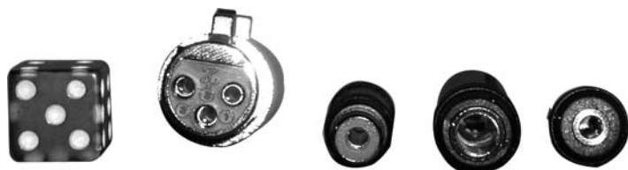
Рис. 5.3. Разъемы XLR, RCA, 1/4" и Mini
