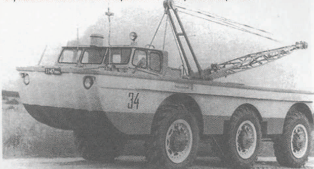
Поисково-эвакуационная установка ПЭУ-1 (1966) с краном для загрузки спускаемых космических аппаратов. Фото из архива В.А.Грачева
