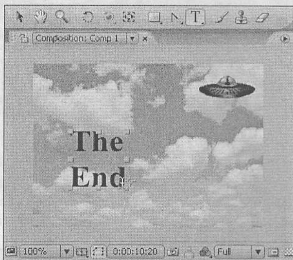
Рис. 11.8. Выделение абзацных титров инструментом Text позволяет затем изменять размер текстового блока без масштабирования в нем текста
